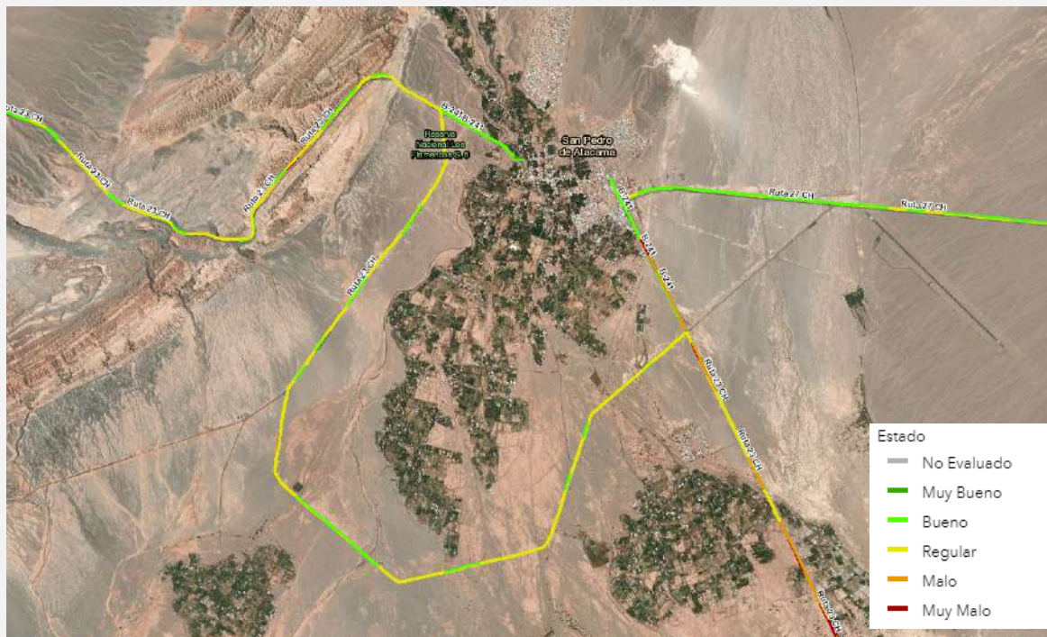
Figura 57. Estado de la Red Vial Pavimentada
